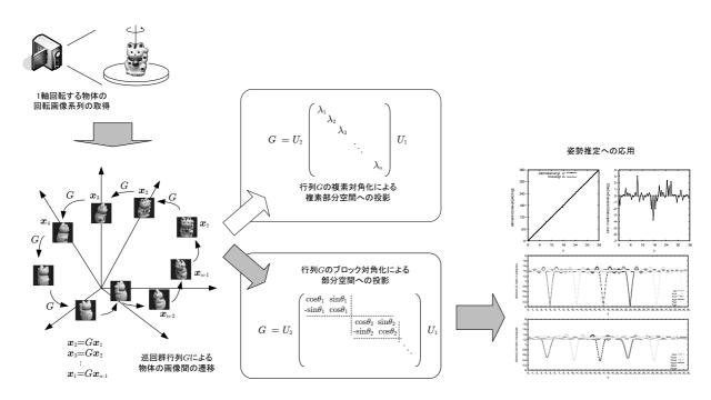
本論文では、1 軸回転する物体の画像ように巡回する画像列が与えられたときに、画像間の関係を複数の 2 次元平面上での回転で表現できるような部分空間への線形写像と、それを用いた姿勢推定手法を提案する。提案手法は、まず画像列に働く巡回群を考え、その群を表現する巡回遷移行列 G をブロック対角化を用いて低ランク行列の積  $G=U_2DU_1$  に分解する。この行列  $U_1$  により画像空間中の画像 x が部分空間へと投影されるが、その部分空間において姿勢推定が有効に行われることを示す。
