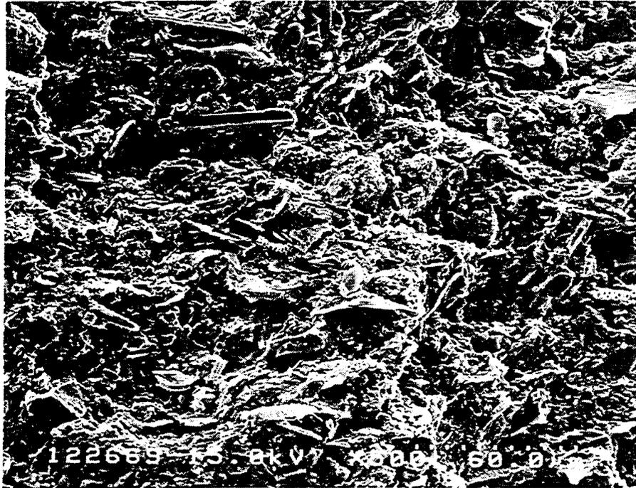
写真-4.3.6 室温養生粘土の鉛直断面
